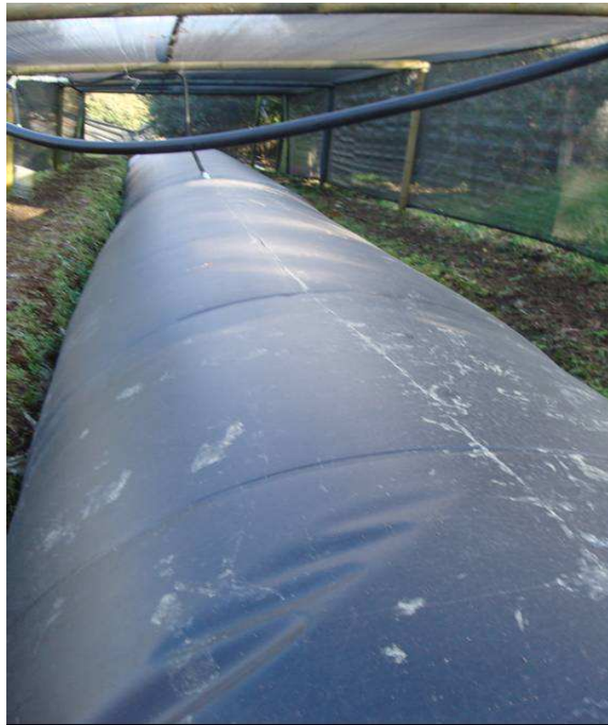
Figura 7: Biodigestor tipo chorizo (Polietileno de alta densidad)
